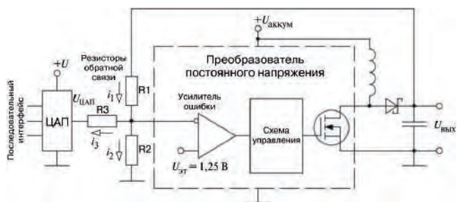
Рис. 1. Преобразователь постоянного напряжения с ЦАП для регулирования выходного напряжения
