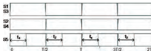
Рис. 5. Закон управления типа "D" для силовых ключей S1-S5 в структурах 2 и 3
