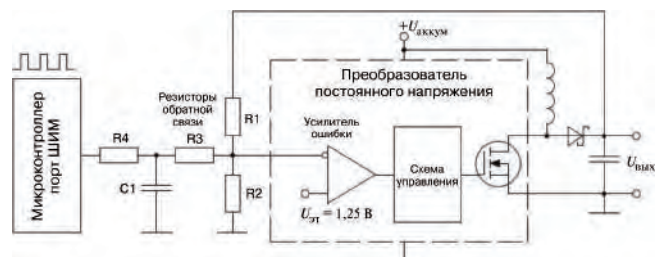
Рис. 3. Преобразователь постоянного напряжения с ШИМ для регулирования выходного напряжения
