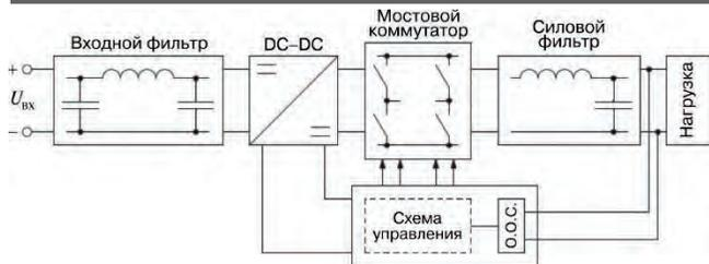
Рис. 1. Функциональная схема инвертора в режиме ШИМ-СИН
