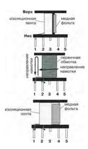
Рис. 15. Способ экранирования для исключения помехоподавляющего конденсатора типа Y
