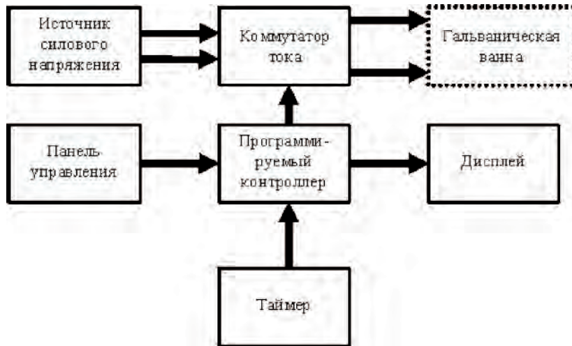
Рис. 3. Функциональная схема программируемого реверсивного источника для гальванической металлизации
