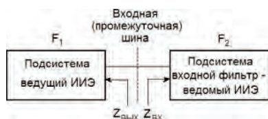
Рис. 3. Эквивалентная схема РЭС с входными фильтрами перед ведомыми ИИЭ
