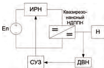
Рис.1 Структурная схема ИВЭП с ИРН в первичной цепи и квазирезонансным НДППН
