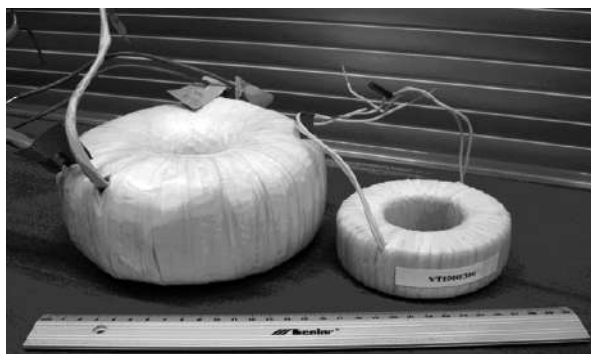
Рис. 2. Трансформаторы бортовой части СЭП ПА TV1 и TV2
