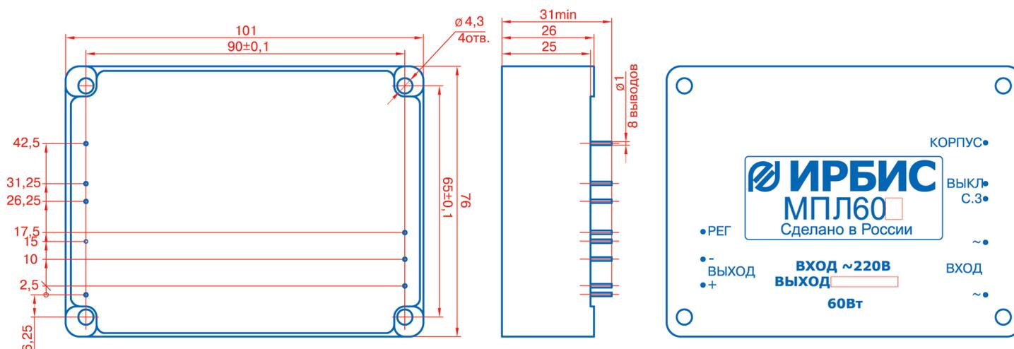
Предельные отклонения размеров между осями двух любых выводов ±0,2.
