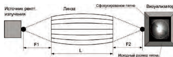
Рис. 5. Схема фокусировки рентгеновского пятна
