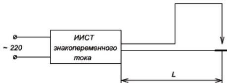
Рис. 2 ИИСТ знакопеременного тока совместно со сварочным кабелем:  $L$  – длина сварочного кабеля
