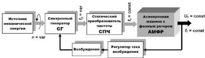
Рис. 1. Блок-схема системы ПСПЧ на основе АСАГ
