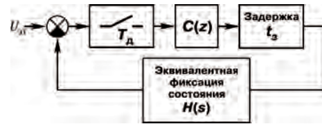
Рис. 2. Модель понижающего преобразователя на основе эквивалентных задержек
