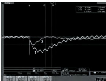
Рис. 1. Переходный процесс при скачкообразном изменении нагрузки (1 – преобразователь с аналоговым управлением; 2 – преобразователь с цифровым управлением)
