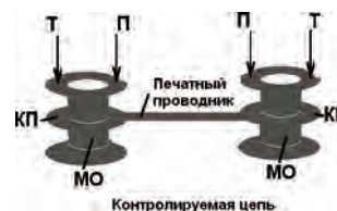
Рис. 3. Схема подсоединения зондов к контролируемой цепи печатной платы: Т и Т — токовые зонды — i(t) , П и П — потенциальные зонды — u(t) , КП — контактные площадки металлизированных отверстий (МО) печатной платы
