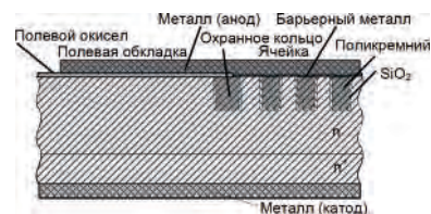
Рис. 1. Поперечное сечение ячейки и охранной области диода Шоттки с МОП канавочной структурой
