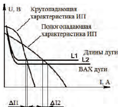
Рис. 1. Нагрузочные характеристики источника питания и статические ВАХ сварочной дуги
