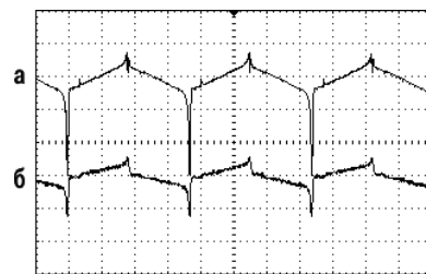
Рис. 3. Подмагничивание магнитопровода постоянным током: а – ток намагничивания трансформатора (1 А/дел.); б – ток первичной обмотки (10 А/дел.)
